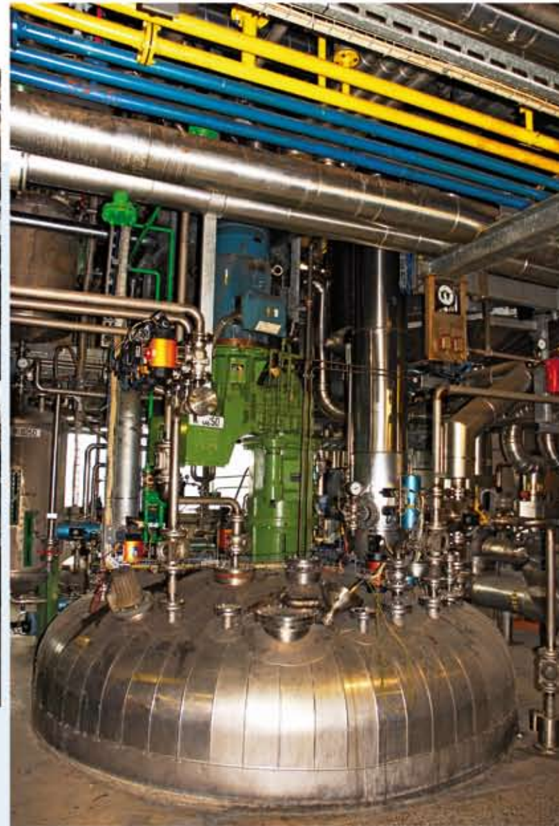
Az úgynevezett sztripperekben az oldószerek gyantából kondenzálódnak ki. Münsterben az illékony oldószereket magas hőmérsékleten veszélyes anyag mentesen égetik el. Ez nemcsak környezetbarát, hanem egy nagyon jó égési anyag is, mellyel a gyantagyár reaktorait fűtik.
