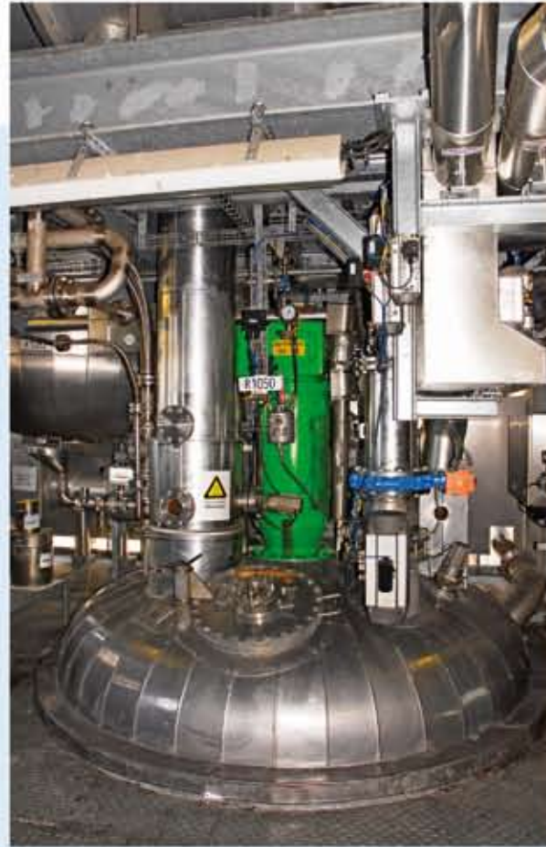
A reaktor a gyantagyártás szíve. Itt zajlik a tulajdonképpeni kémiai reakció. A zökkenőmentes működés érdekében minden reaktor egy fűtő-hűtő berendezéssel, valamint a hőmérséklethez, nyomáshoz és átfolyáshoz szükséges mérési technikával van felszerelve.
